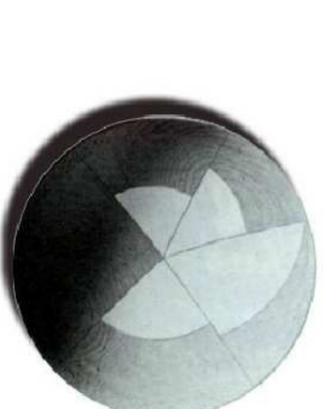
Figura 5. Superficies de la cubierta de la Ópera de Sydney resultante de la misma geometría esférica.
