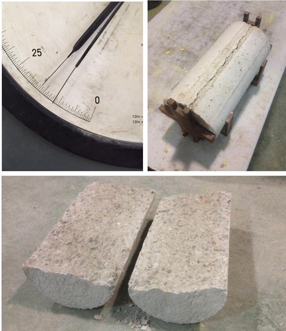
Figura A.2 Detalles del ensayo de una probeta por tracción indirecta
