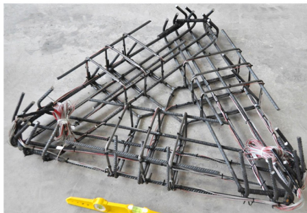
Figura 5.9 Especímenes con armadura vertical entre pilotes pertenecientes a la campaña experimental de Clarke [2], Miguel M.G [64] y la presente investigación
