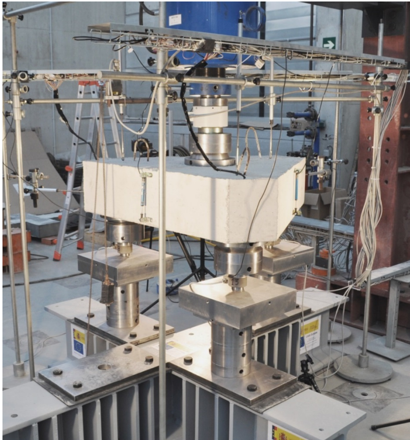
Figura 3.16 Vista general del ensayo de encepados de tres pilotes
