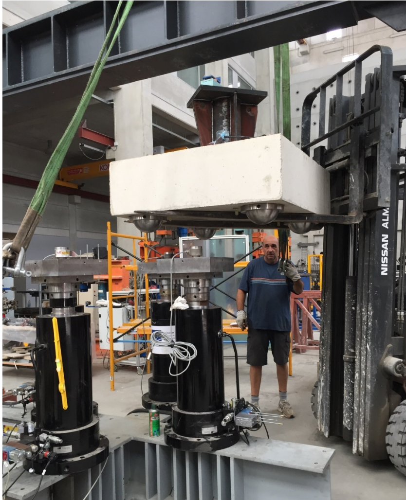
Figura 3.20 Colocación del encepado de cuatro pilotes
