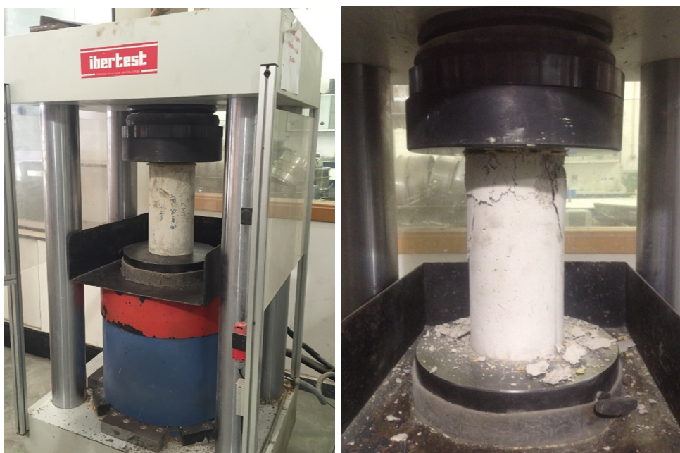
Figura A.1 Ensayo de compresión simple del hormigón: a) Vista general del ensayo; b) Probeta tras la rotura
