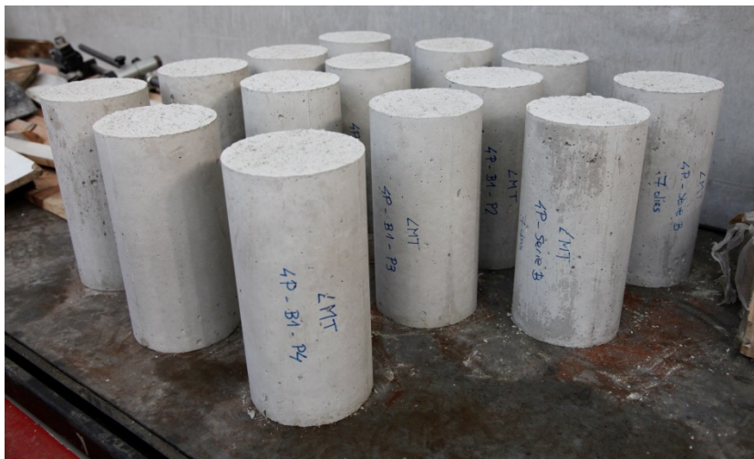
Figura 3.7 Probetas de acompañamiento de los especímenes de la serie 4P-N
