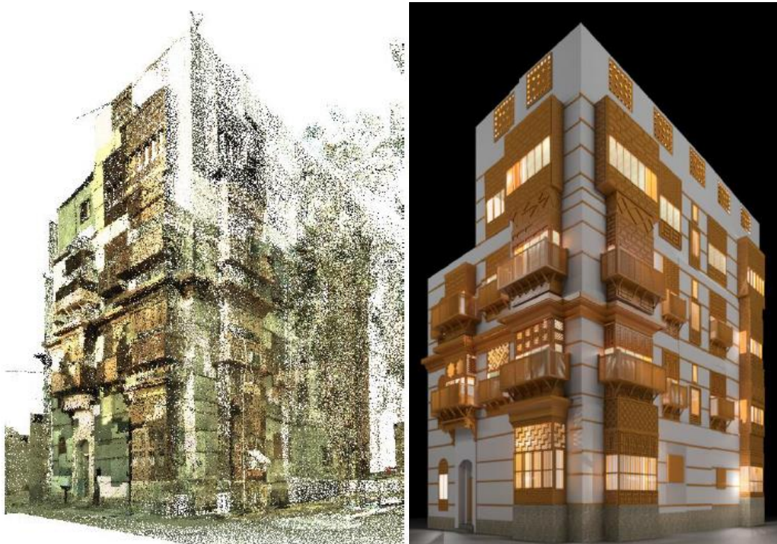
Ilustración 8. Nube de puntos vs Modelo 3D en Revit. Fuente (Baik, Boehm, & Robson, 2013)
