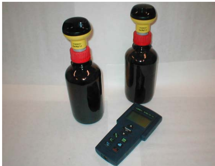
Figura 2.41. Respirómetros de 1,5 litros de volumen.
