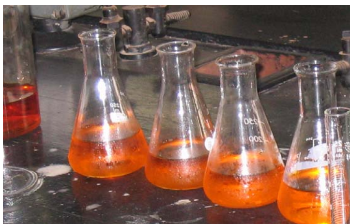
Figura 2.16. Valoración de la materia orgánica en el método de WALKEY Y BLACK.
