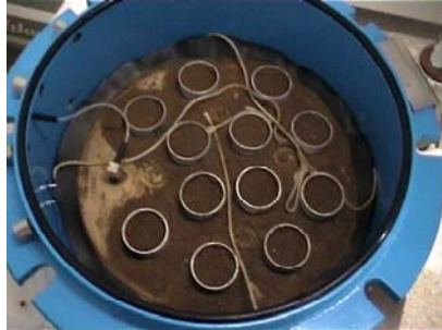
Figura 2.33. Muestras introducidas en la membrana de RICHARDS
