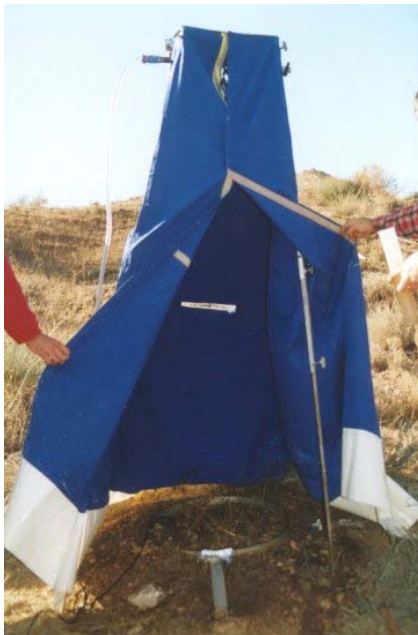
Figura 2.43. Simulador de lluvia elementos y características
