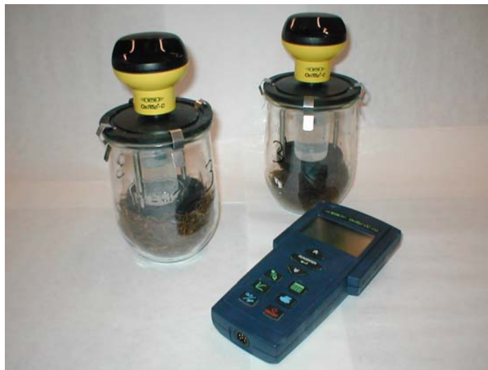
Figura 2.41. Respirómetros de 1,5 litros de volumen.
