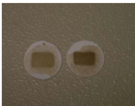
Figura 2.21. Pastillas (muestras presionadas con KBr)
