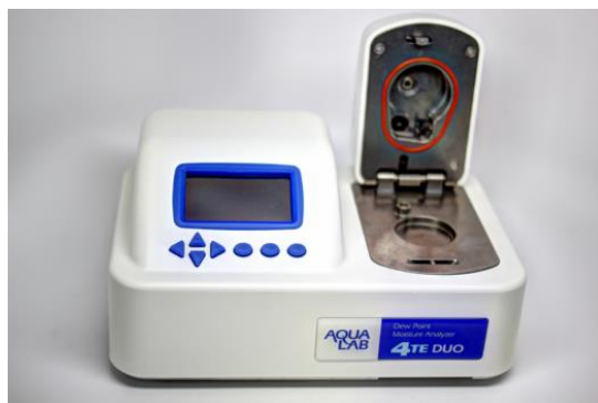
Figura 10. Higrómetro de punto de rocío con el que se realizaron las determinaciones de la actividad de agua de las galletas
