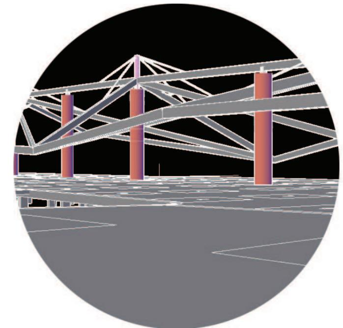
*pilares hormigón sección circular, vigas de acero en cubierta y tirantes*
