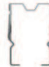
Sección travesaño M: 25x38x0,8 mm
