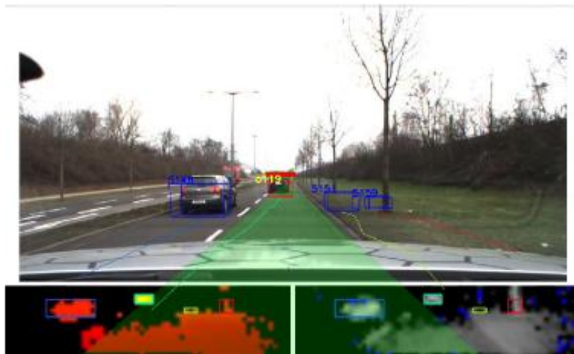
Figura 8: Visualización del algoritmo, la imagen inferior muestra el sensor de datos como imagen profundizada a la izquierda y la intensidad de imagen a la derecha. Fte: (Kohlhaas et al., 2013)
