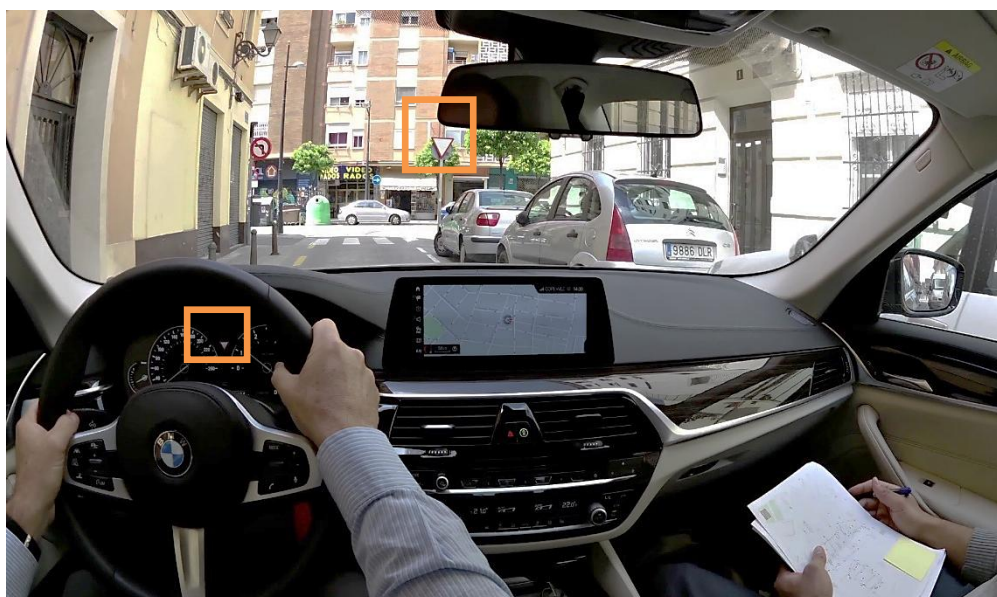
Figura 60: Detección de señal de Ceda el Paso.
