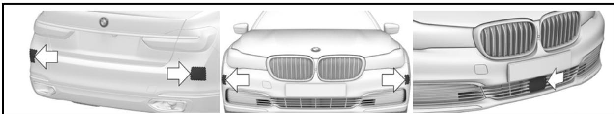
Figura 14. Configuración de los radares. Fte. Manual de Usuario BMW Serie 5.
