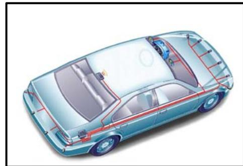
Figura 11. Configuración usual de los sensores de ultrasonido en sistemas de parqueo. Fte. Neobotix components
