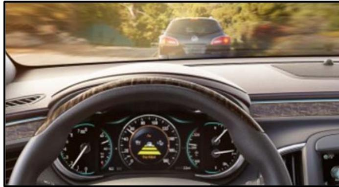
Figura 33. Indicación en tablero de control adaptativo de cruceo activado. Fte. Mercedes-Benz
