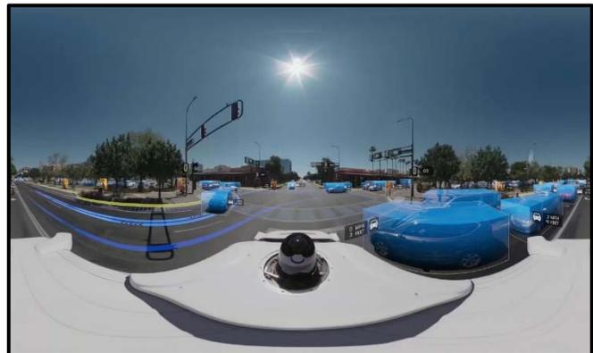
Figura 24. Entendimiento del entorno y predicción de las posibles rutas de esos objetos. Fte. Waymo
