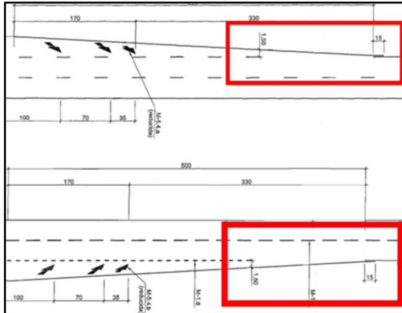
Figura 98. . Vano en las marcas viales de entradas y salidas exigidos por la norma. Fte. Norma 8.2 IC: Marcas viales
