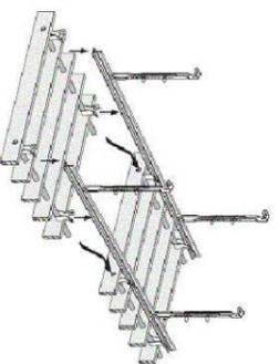
Techo de madera lineal, colocación tipo grilla. (Hunter douglas):
