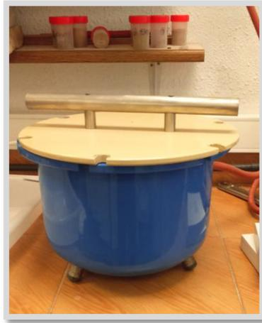
**Figura 21.** Placas de presión empleadas en el método Richards (Elaboración propia, 2018).
