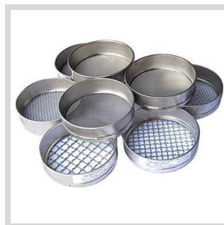
**Figura 14.** Torre de tamices empleada de la marca Prosega (fuente: <http://www.Prosega.com>).
