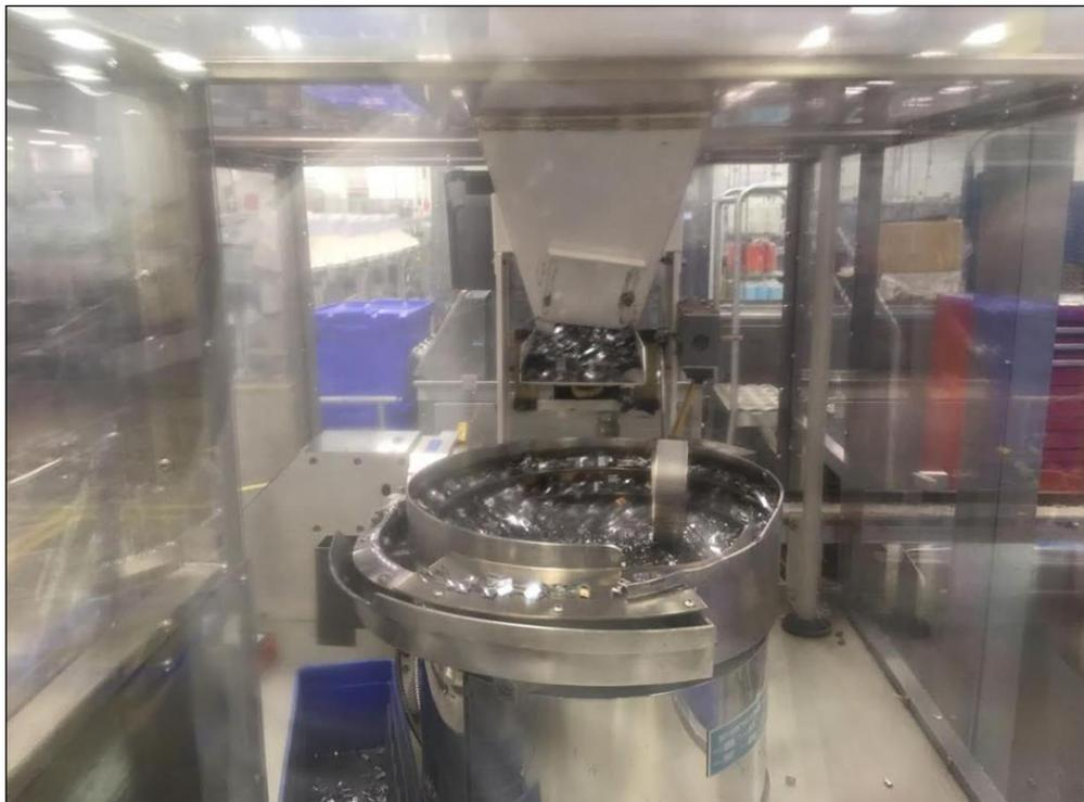
*Ilustración 7: "Tolva de máquina con cortadores en el centro de Cutter-Insert"*
