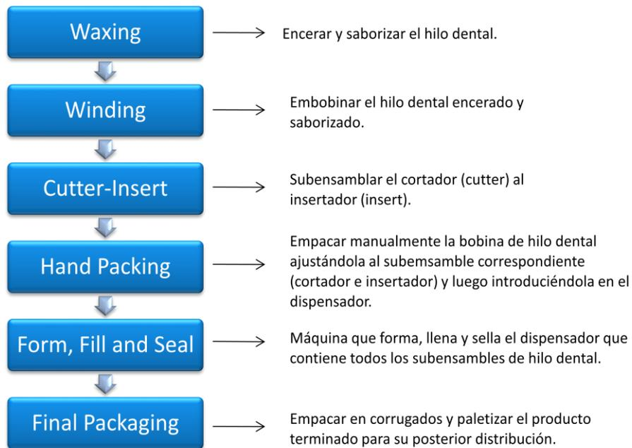
*Ilustración 12: "Flujo de proceso manufactura de hilo dental en Johnson & Johnson, Dental Care, República Dominicana"*
