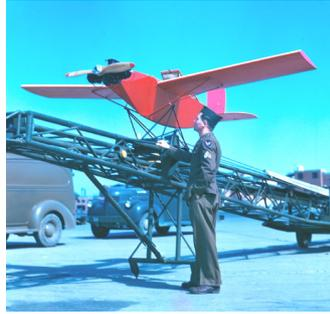
**Figura 2.1:** Un avión radiocontrol y su lanzador Wright Field, Octubre 1945.
