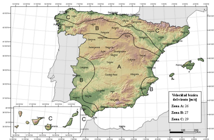
Figura 10. Valor básico de la velocidad del viento
