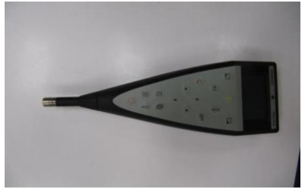
Sonómetro. Para tomar lecturas de niveles de intensidad sonora, a ruido aéreo y a ruido de impacto.
