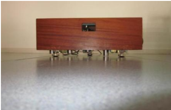
Máquina normalizada de impactos. Para emitir ruido de impacto.
