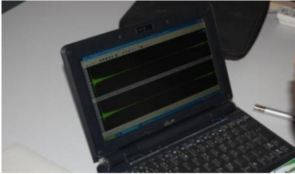
Emisor de impulsos sonoros. Aplicación Dirac de B&K Para medir tiempo de reverberación.
