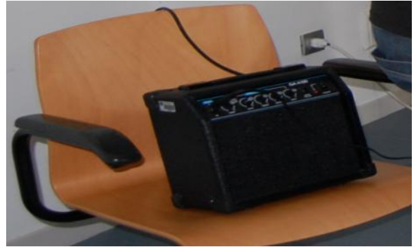
Amplificador de guitarra. Para medir tiempo de reverberación.
