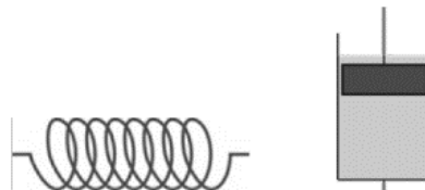
Figura 5: Representación esquemática de los elementos físicos que simbolizan la componente elástica (muelle) y la componente viscosa (pistón) [14].
