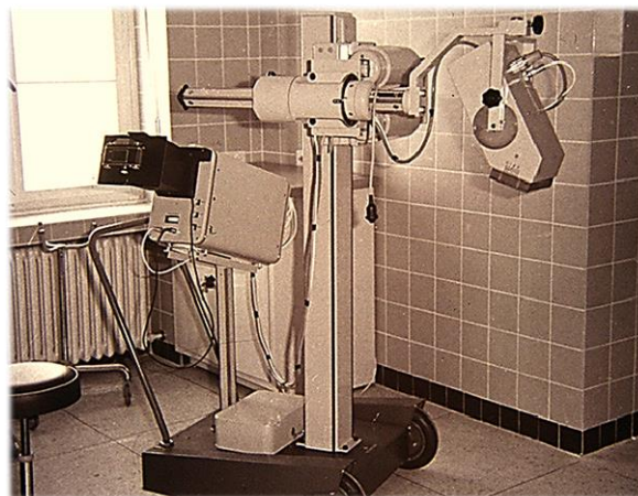
Figura 12: Prototipo Vidoson : Consola de visualización (izquierda), suspensión de montaje tridimensional (centro), y escáner de ultrasonidos Soldner (derecha) [15].
