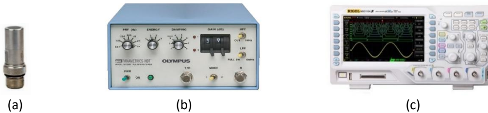
Figura 18: (a) Transductor ultrasónico Olympus Panametrics V320-SU-F. (b) Pulser-Receiver Olympus 5072PR. (c) Osciloscopio Rigol MSO1104Z-S.
