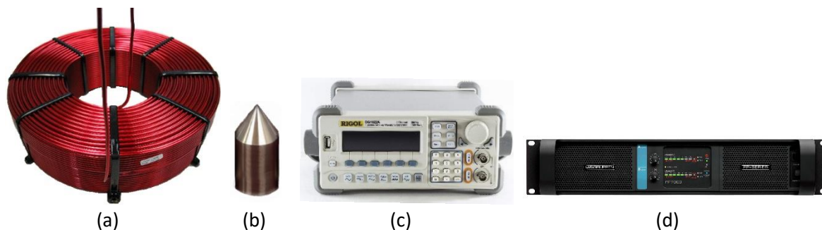
Figura 17: (a) Solenoide S1013 de Solen Électronique Inc. (b) Núcleo de acero ferrítico (AISI 430). (c) Generador de funciones Rigol DG1022. (d) Amplificador FP14000
