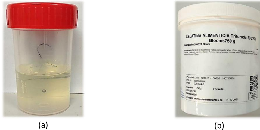
Figura 22: (a) Phantom de gelatina con esfera ferromagnética. (b) Gelatina alimenticia triturada.
