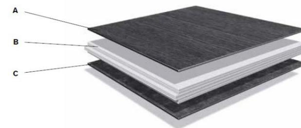
Se recomienda la instalación en el sentido longitudinal de la habitación, puesto que la lama experimenta menos movimientos longitudinales que transversales. Esto tiene especial importancia en recintos largos y estrechos para que las lamas queden planas sobre el subpavimento.
