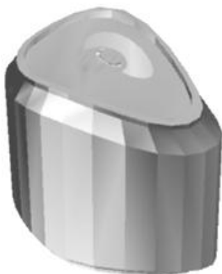
Lata achatada y curvada, perdiendo la forma circular en las bases
