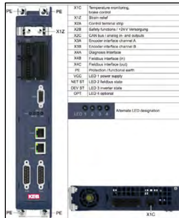
Figura 61 Partes del Servo drive
