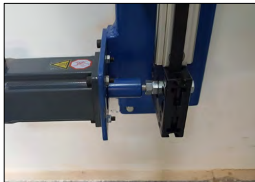
Figura 101 Montaje del motor sincrónico de imanes permanentes a la unidad lineal.
