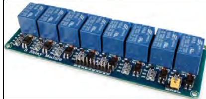
Figura 78 Tarjeta de 8 relés de 5V optoaislados a 10A
