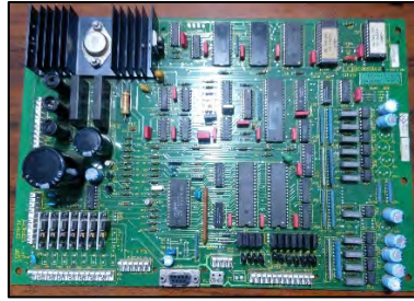
Figura 14 Tarjeta de control velocidad Otis Lcb2
