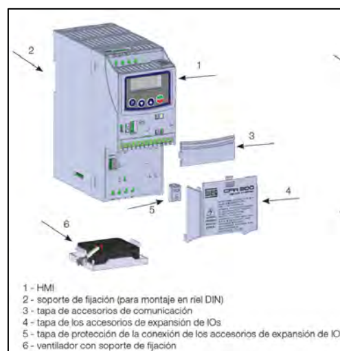
Figura 49 Partes del variador de frecuencia WEG cfw300
