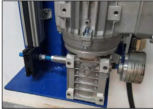
Figura 100 Montaje del motor asincrónico de inducción en la unidad lineal.
