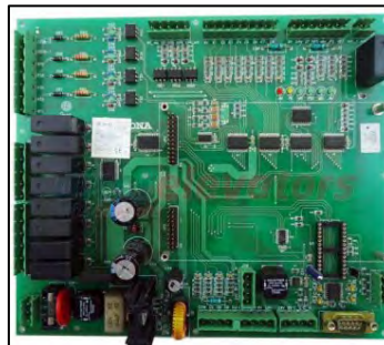
Figura 16 Tarjeta de control velocidad Orona
