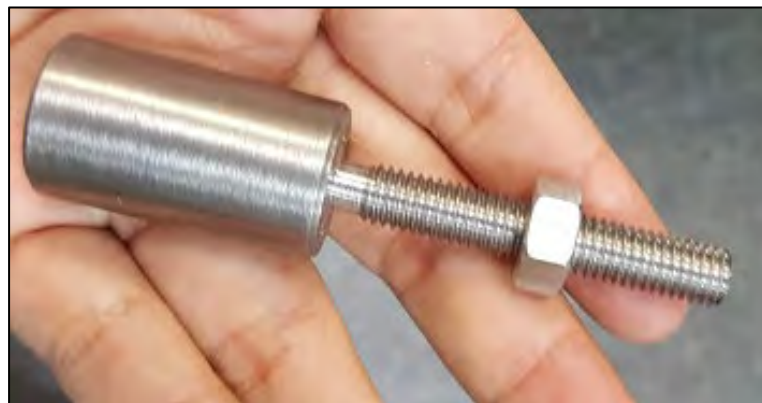
Figura 37 Implementación real del acople servomotor-unidad lineal
