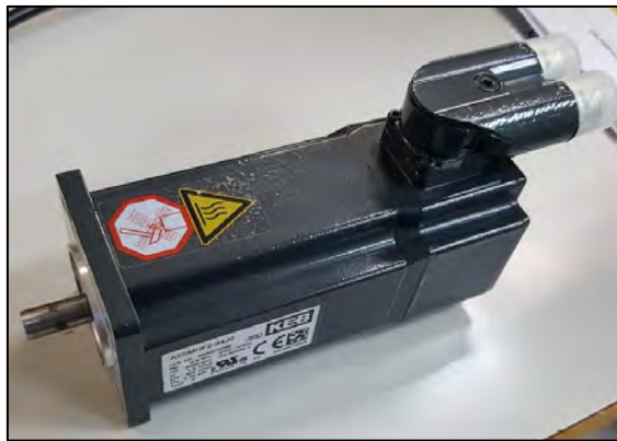
Figura 52 Motor sincrónico de imanes permanentes A2SMHF2-87J0
