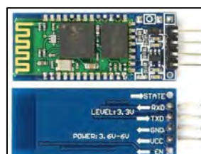
Figura 80 Modulo HC06, pines de funcionamiento
