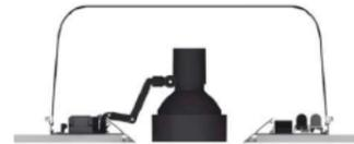
Sistema modular compuesto concebido para la realización de perfiles empotrables de tipo "frameless" de abertura variable. De forma que no quedan vistos los perfiles metálicos.
