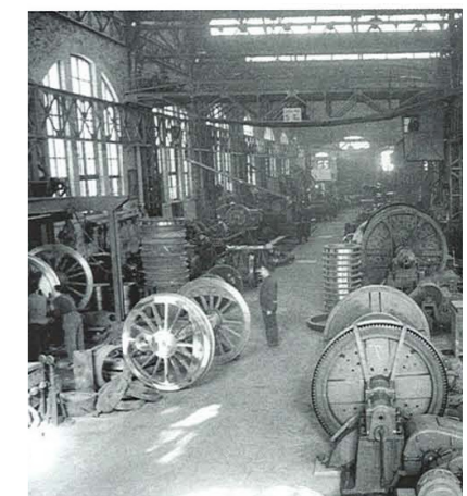
Vista interior de naves de máquinas-herramientas en 1956. José Cortes en primer término en un torno de perfilar ruedas DEVIS (1947). C.F. nº 452
