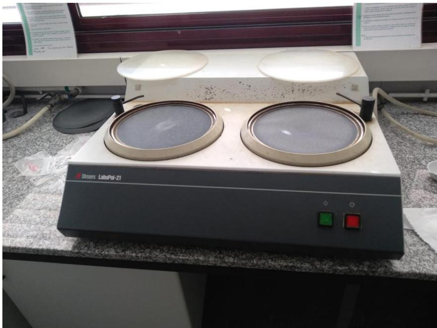
*Ilustración 26 Desbastadora Struers*
