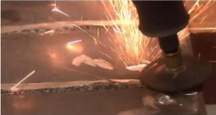
*Ilustración 15 Desbaste mediante amoladora*
