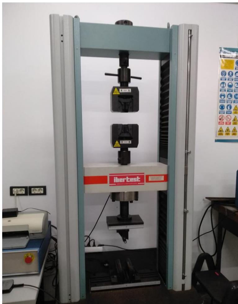
*Ilustración 19 Maquina Universal Ibertest*
