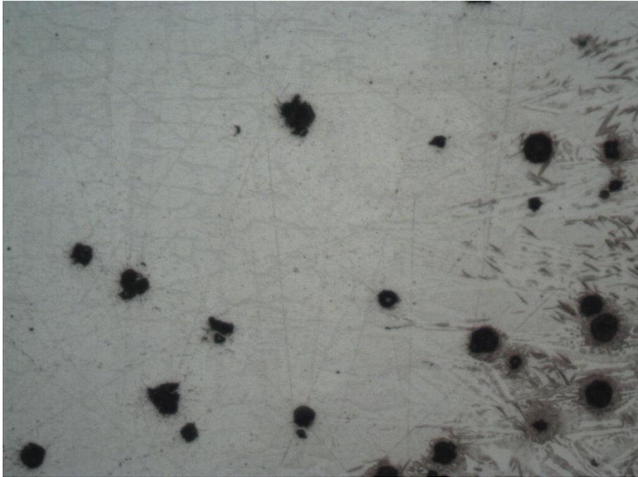
Estructura básica de Aleación Fe-Ni con algunos carburos y grano austenítico dendrítico casi no visible.
