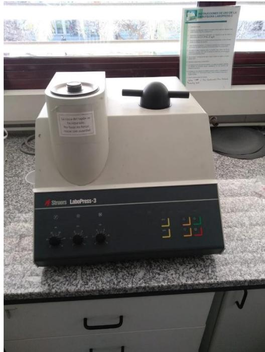
*Ilustración 25 Máquina de embutición
