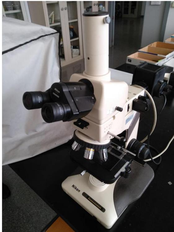
*Ilustración 27 Microscopio metalográfico*
