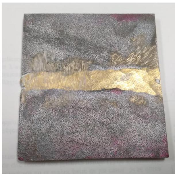
*Ilustración 16 Soldadura nodular Fe-Ni*
