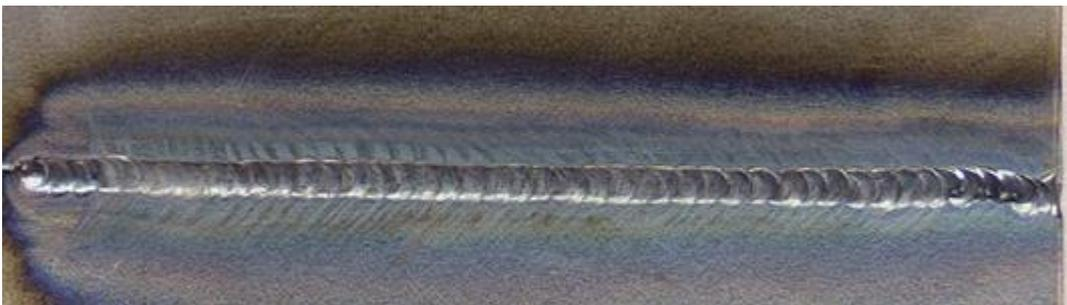
*Ilustración 14 Cordón de soldadura*
