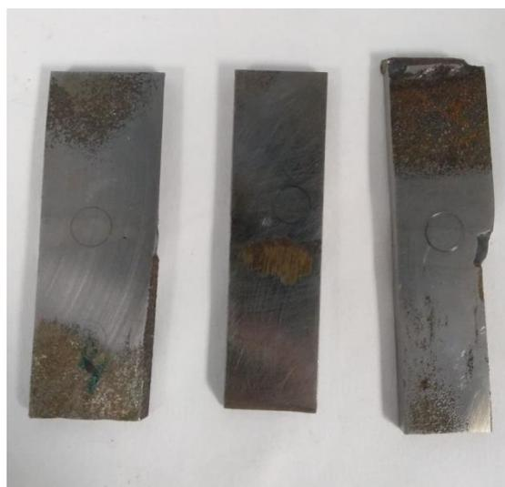
*Ilustración 23 Probetas sometidas a ensayo tribológico*
