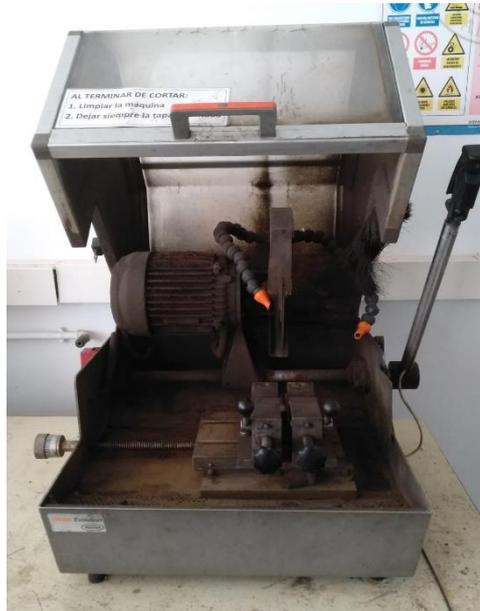
***Ilustración 17 Sierra de accionamiento manual***
