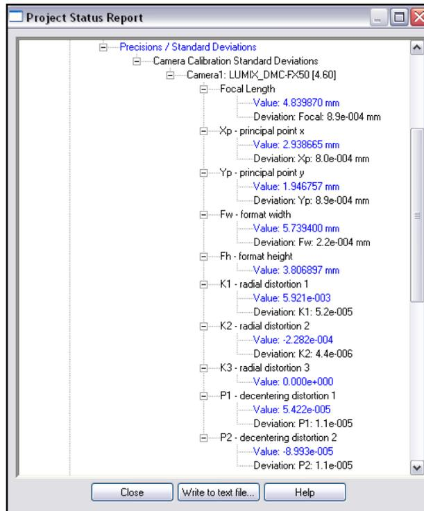
Una vez realizada la calibración de la cámara hemos procedido a realizar las fotos del Arco de entrada del Castillo. Se han tomado prácticamente 90 fotos teniendo en cuenta el condicionante de que se tomase la superficie completa del Arco desde puntos de vista distintos y que el ángulo formado por las mismas estuviese aproximadamente entre 30° y 60°.
