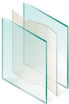
El uso más frecuente de los vidrios laminares lo encontramos en las lunas de seguridad. Combinando distintos espesores obtendremos resistencia a golpes o impacto de proyectiles, sin que salten esquirlas o el vidrio caiga, gracias a la unión de plástico (PVB) o resinas. Se aplica en protecciones antirrobo de bancos y en vidrios de lucernarios o grandes acristalamientos.
