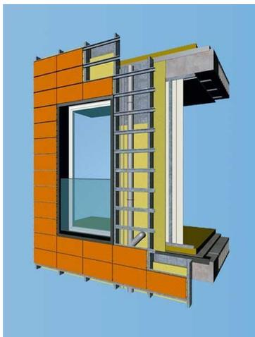
Se trata de un sistema constructivo que permite la fijación de un revestimiento (no estanco) independiente de la hoja de cerramiento.
