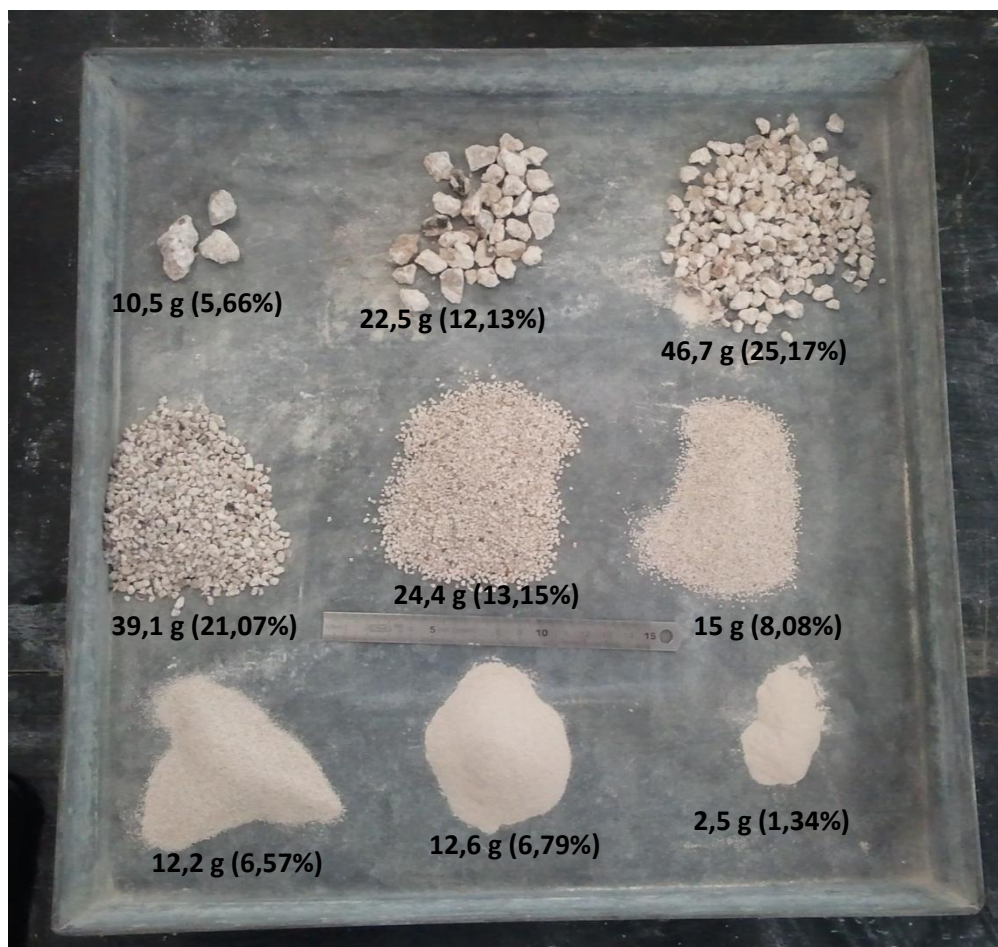
Fotografía 62. Granulometría del árido obtenido del conglomerante utilizado para las almenas
