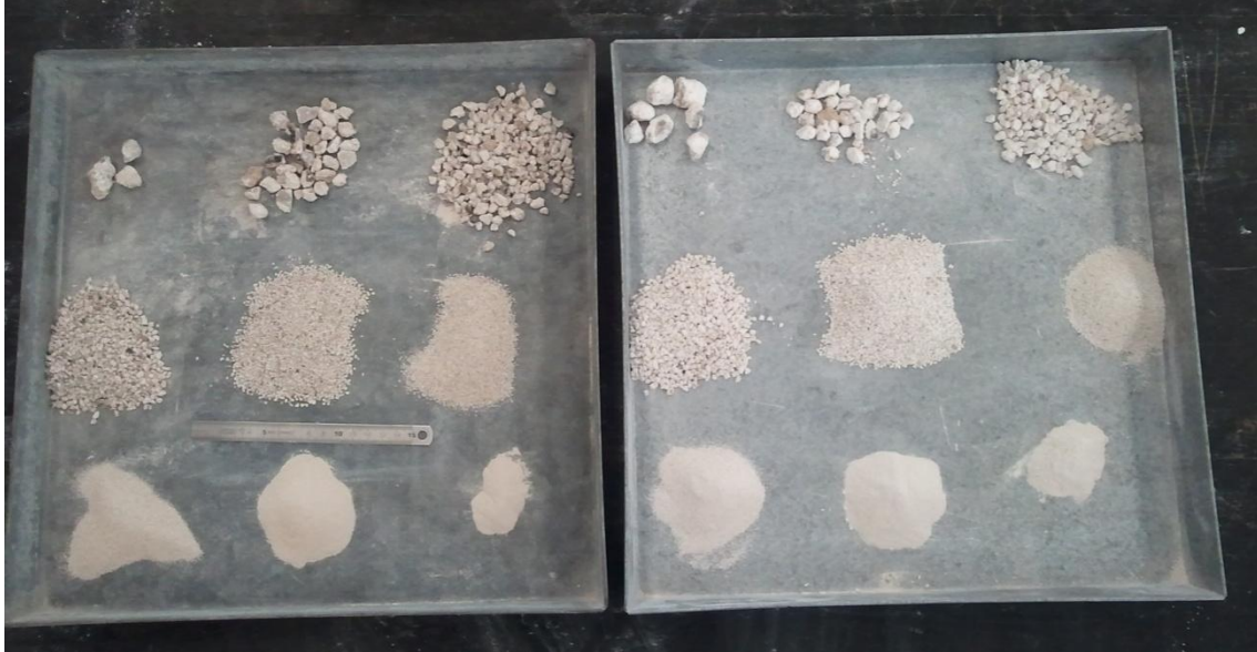
Fotografía 64. Granulometrías de los áridos ensayados
