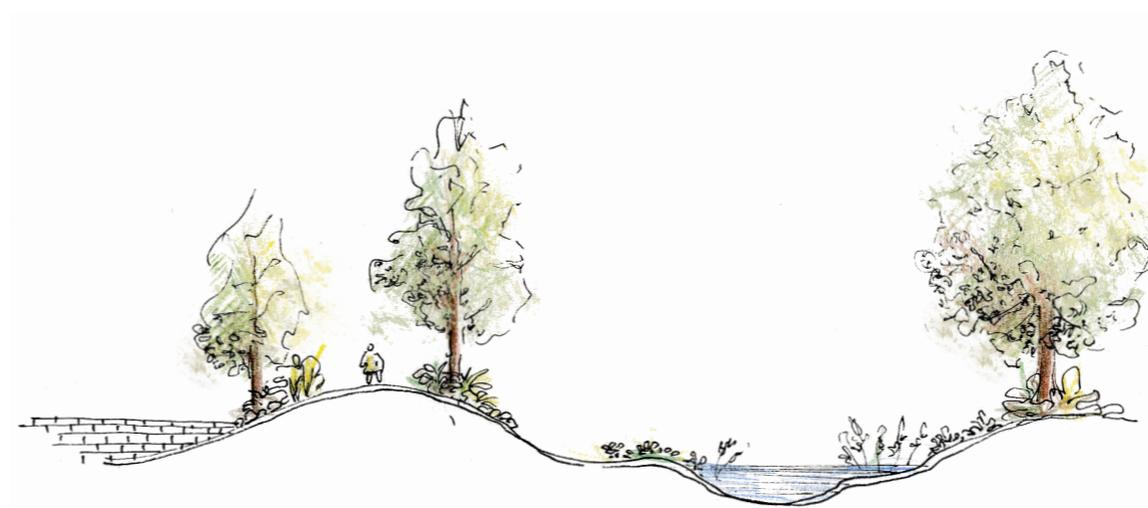
**Áreas urbanas** / El agua recogida en tejados y estacionamiento es gestionada en una cisterna para ser reutilizada o evacuada hacia la línea de alcantarillado de aguas pluviales hasta llegar al humedal. Las cubiertas verdes, pavimentos permeables, plantadores de filtración y captación de aguas deben estar bien adaptados.
