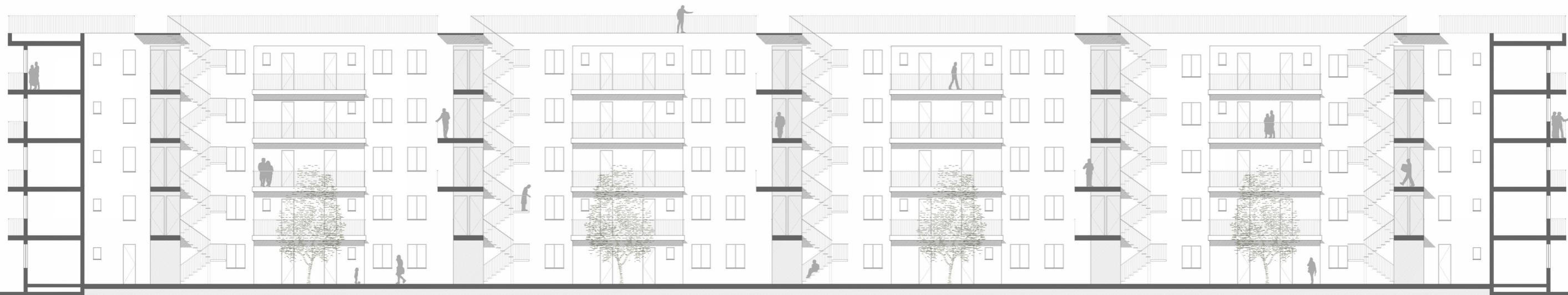
sección longitudinal por el patio interior de las viviendas con el nuevo núcleo de escalera exterior
