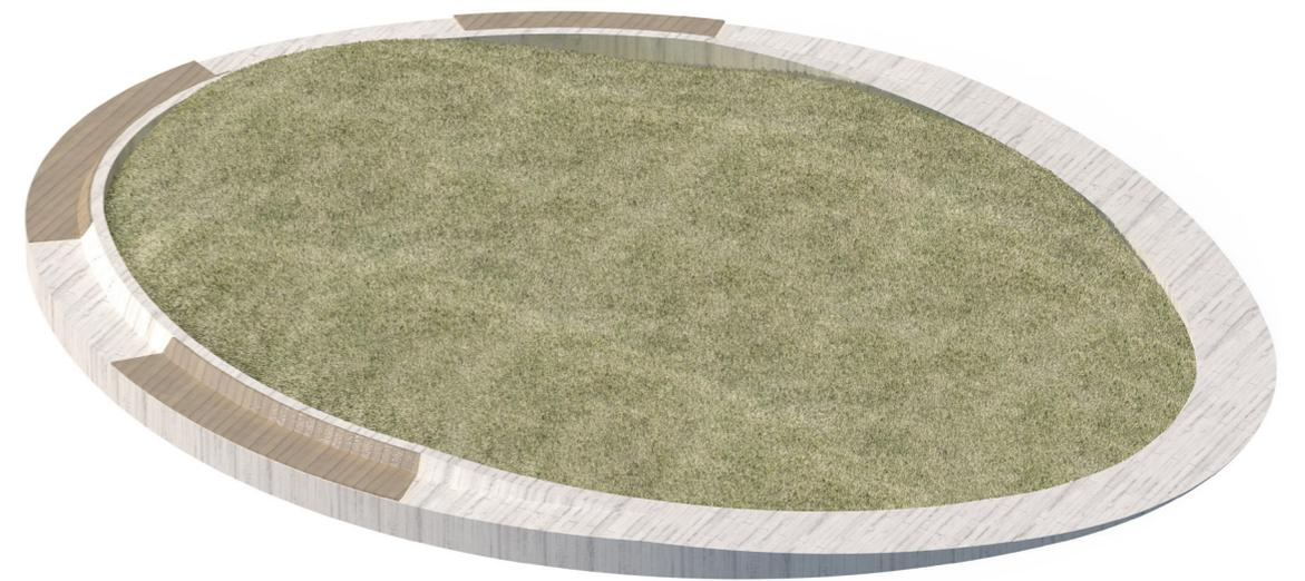
Diseño de una de las piezas de mobiliario de hormigón macizo con el terreno
