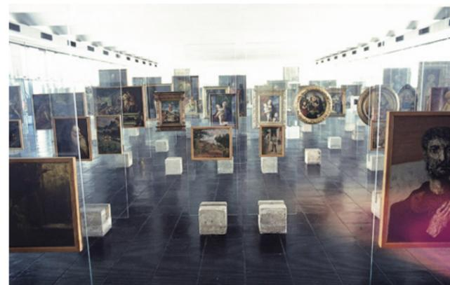
En la sala de exposiciones estará dotada con unos expositores similares a los diseñados por Lina Bo Bardi, compuestos por un cubo de hormigón como soporte y un vidrio donde se colocarán las obras a exponer.
