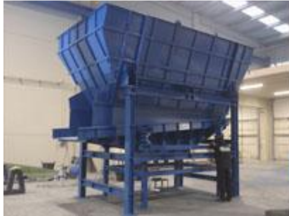
Figura 33. Tremuja d'alimentació amb vibrant d'alimentació seleccionada Font: Dartek [34]
