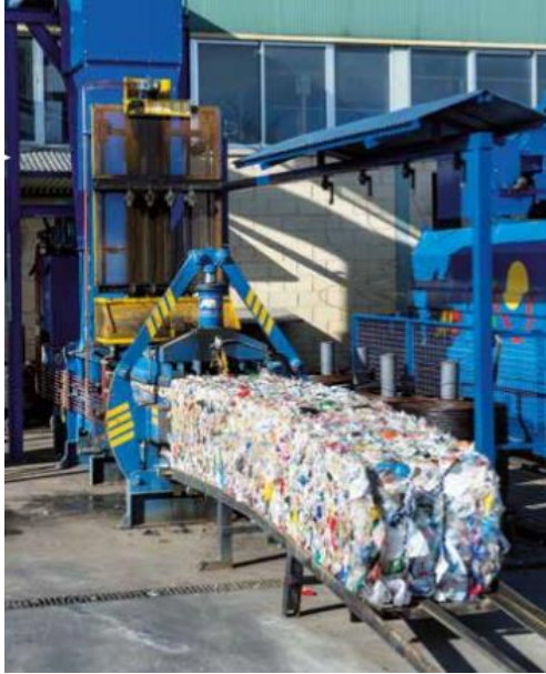
Figura 22. Emmagatzematge en piles premsades de les fraccions separades Font: Plantes de selecció d'envasos lleugers (Ecoembes) [20]
