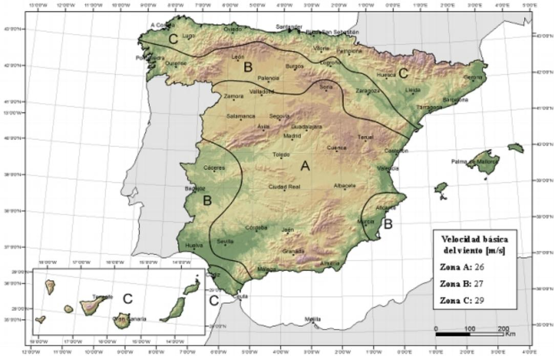
Imagen 2. Valor básico de la velocidad del viento (CTE DB-SE-AE)
