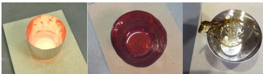
Figura 6.6. Fusión de un suelo con LiBO 2 y Li 2 B 4 O 7 (80/20): crisol caliente (izquierda y centro), restos enfriados tras ser vertido el fundido (derecha).
