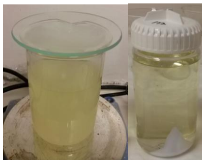
Figura 5.8. Precipitación de oxalatos y separación por centrifugación.
