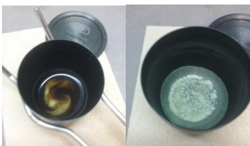
Figura 6.7. Fusión de un suelo con NaOH: crisol caliente (izquierda), tras 10 min. de enfriamiento (derecha).
