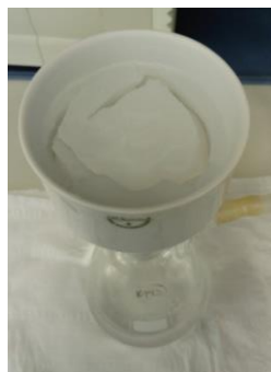
Figura 6.8. Gel formado en el pretratamiento de la muestra por fusión con boratos.
