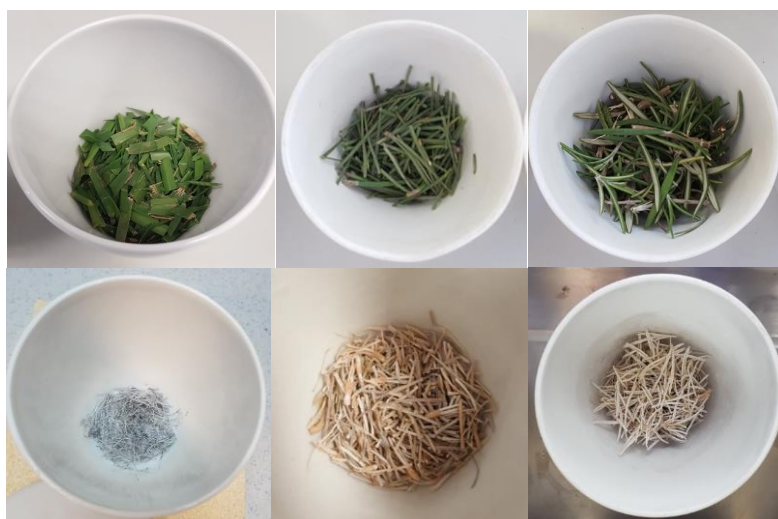
Figura 5.13. Muestras de 5 g de césped, pino y romero antes y después de la calcinación rápida.
