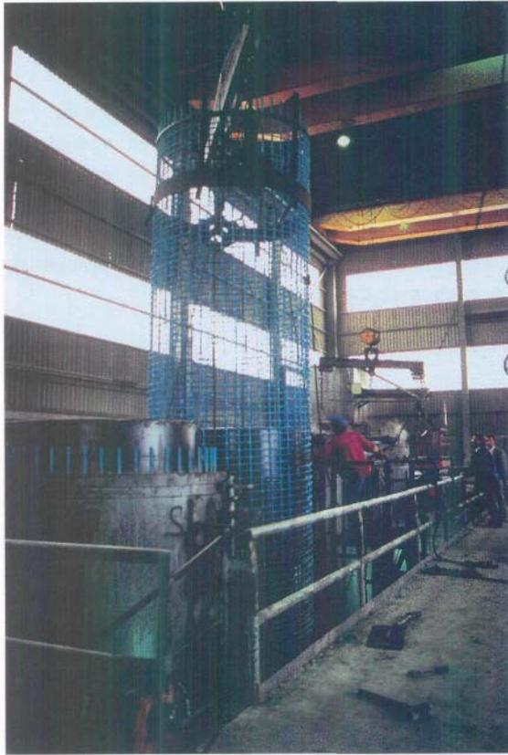
*Figura 13. Introducción de las armaduras.*
