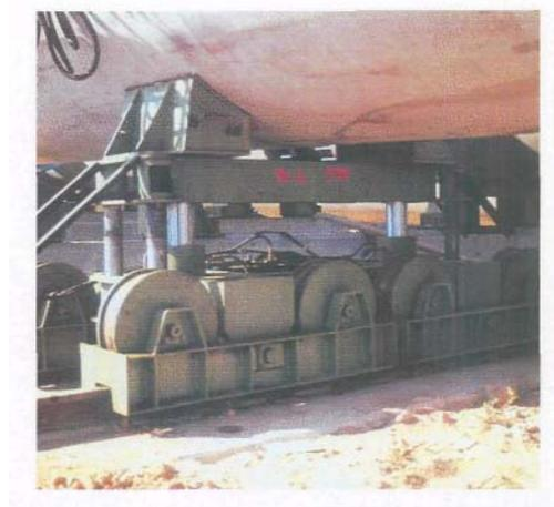
*Figuras 22 y 23. Sistema hidráulico para el desplazamiento de los tramos.*
