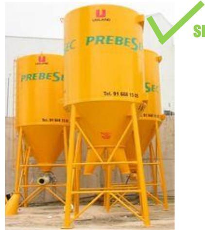
Silos dosificadores de acopio de material a pie de obra
