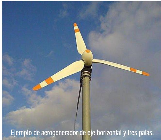
Ejemplo de aerogenerador de eje horizontal y tres palas.
