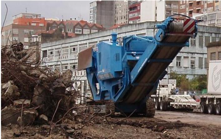
Planta trituradora de escombros, autopropulsada con reciclaje de acero de armar del tipo Premiertrack 1100\*800. Trituradora de mandíbula, alto rendimiento de gran capacidad.
