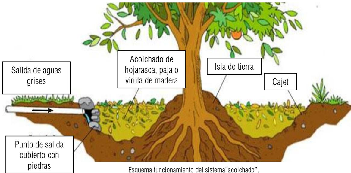
Esquema funcionamiento del sistema "acolchado".
