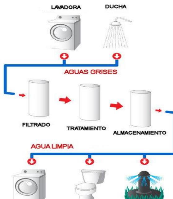
**L** Sistema de funcionamiento de sistema de tuberías independiente
