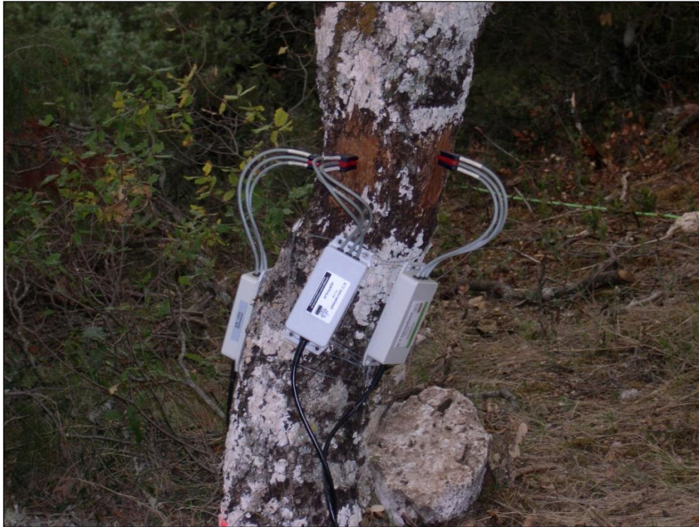
Figura 17- Sensores de flujo de savia instalado en el sitio de estudio (UPV, 2018).
