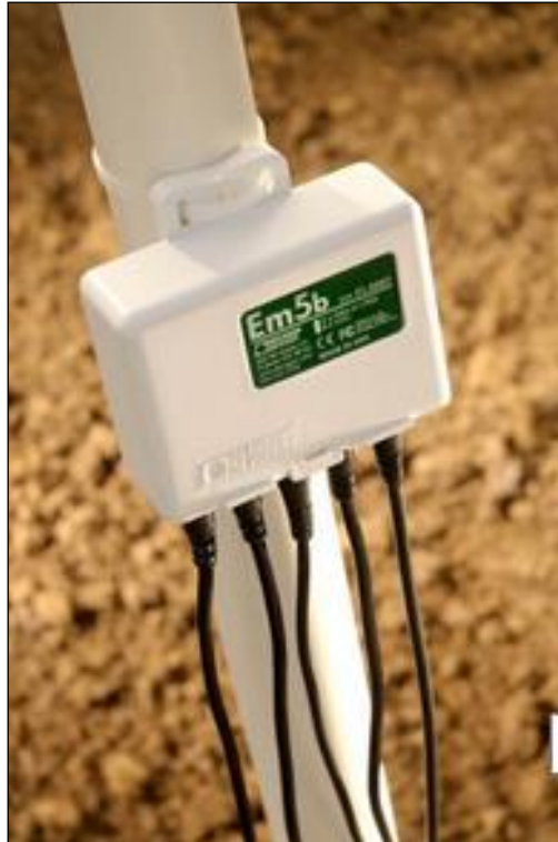
Figura 11- registradores de datos EM50 (Decagon, 2019).
