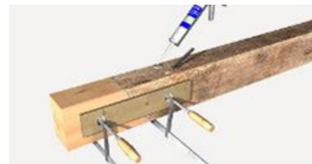
Fig. 11.33 Detalle reparación cabeza de viga. Fuente: generador de precios.
