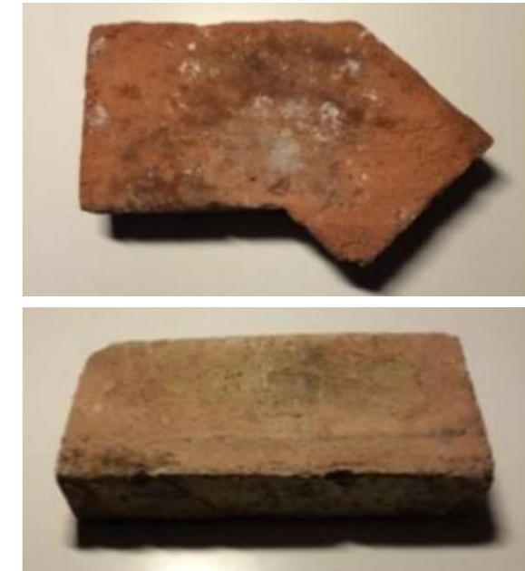
Fig. 10.94 (Arriba) Piezas empleadas en la construcción de la chimenea. Ladrillo aplastillado de esquina y ladrillo de dimensión estándar. Fuente: (Ivorra, y otros 2015)
