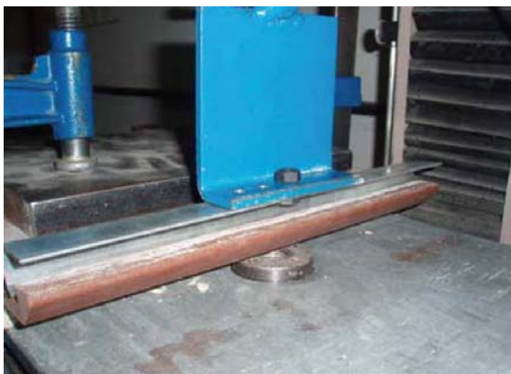
Ensayo de resistencia de la ranura del revestimiento.
