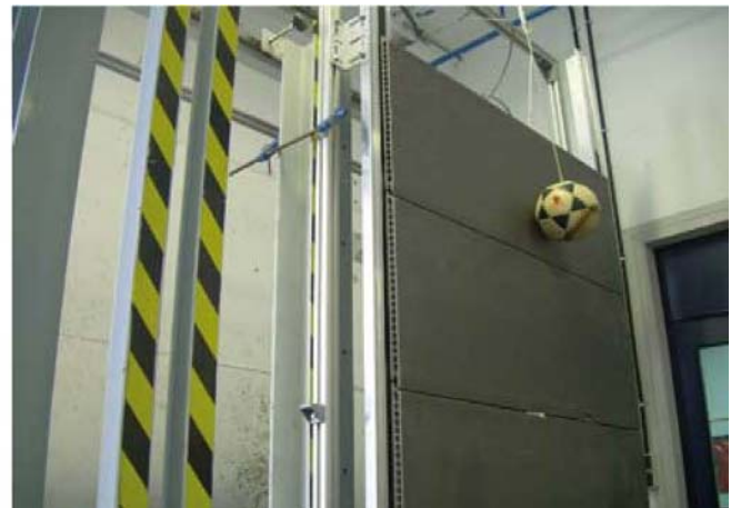
Ensayo de impacto de cuerpo blando (3 kg).
