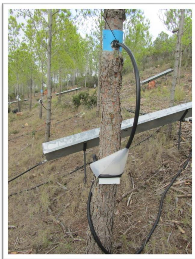
*Figura 15.- Medición de escorrentía cortical*
