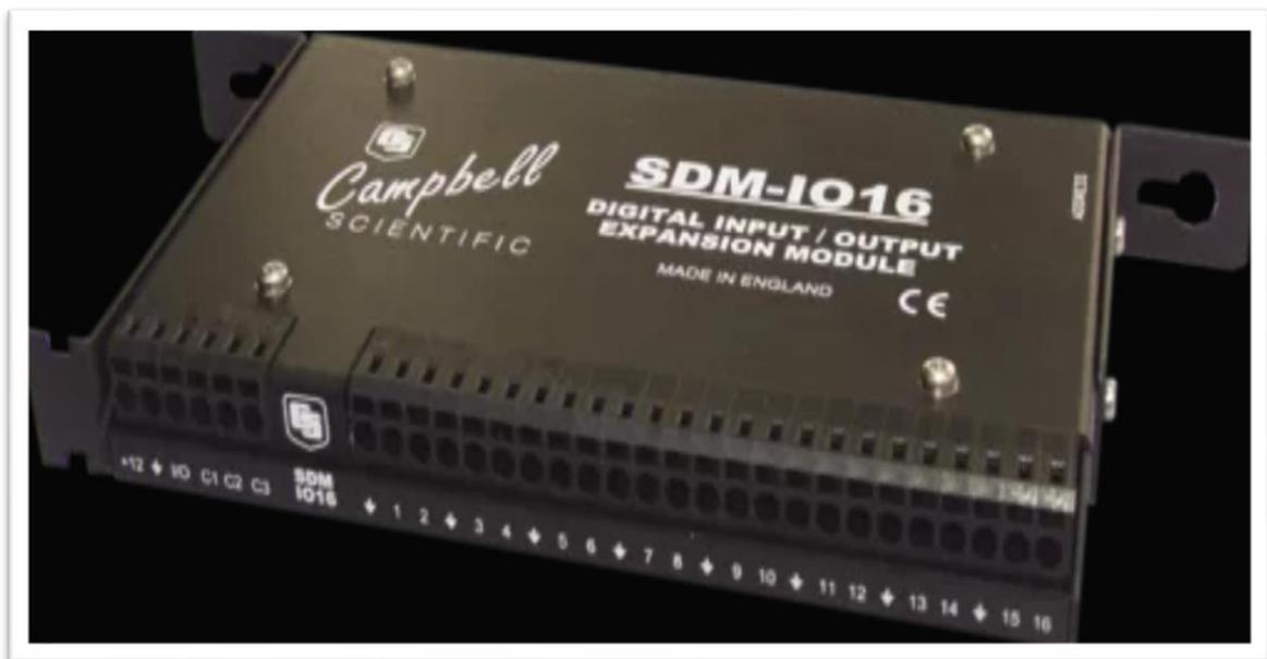
Figura 11.- Modulo de expansión SDM-IO16 (CAMPBELL, 2018c)
