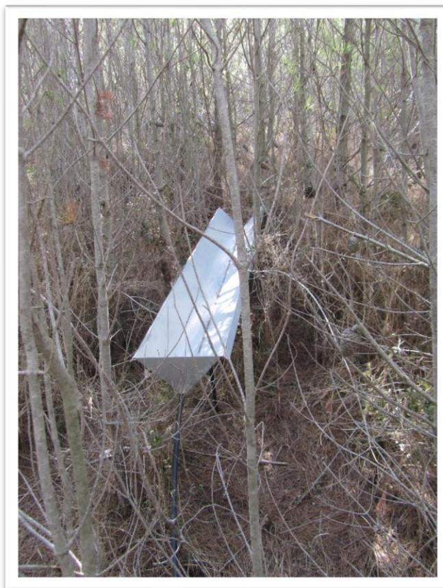
Figura 14.- Canalones utilizados para medir la trascolación en las parcelas
