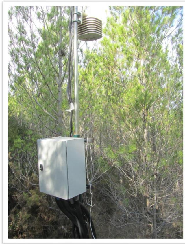
*Figura 12.- Unidad central data-logger instalada en el lugar de estudio*
