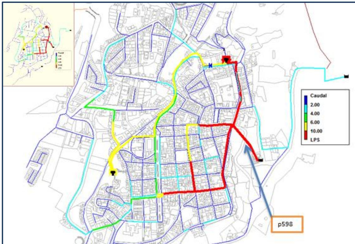
Figura 5.2. Tuberías con mayor transporte de caudal.
