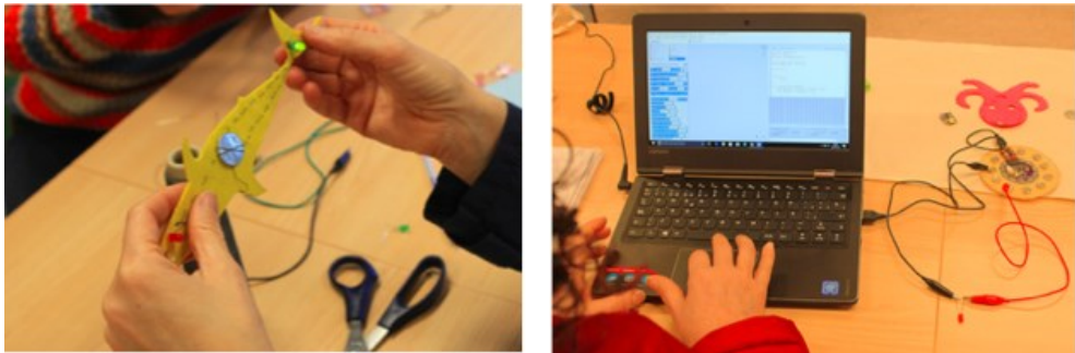
Fig. 3 y 4. Profesoras creando su primer circuito en textil y programando con Mblock la placa Lilypad Arduino
