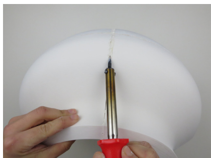
Figura 48. Fundiendo el material en la zona de las uniones de las partes del soporte.
