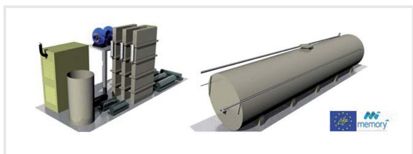
Figura 4. Planta demostración de AnMBR cofinanciada por la Comisión Europea a través del proyecto LIFE MEMORY, liderado por FCC Aqualia. Alcázar de San Juan (Ciudad Real)
