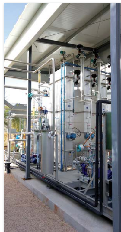
Figura 4. Planta demostración de AnMBR cofinanciada por la Comisión Europea a través del proyecto LIFE MEMORY, liderado por FCC Aqualia. Alcázar de San Juan (Ciudad Real)
