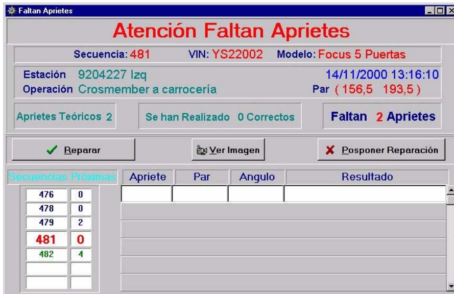
Fig 6.8 Ventana de aviso por falta de aprietes
