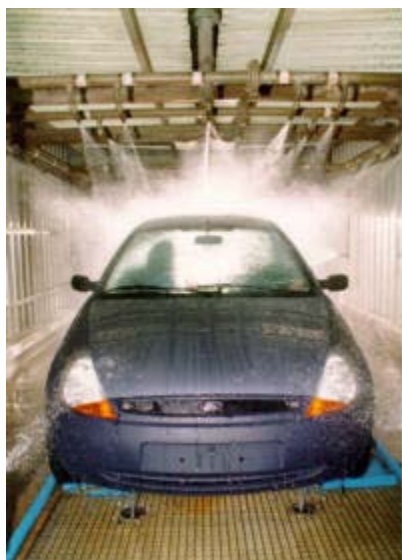
Fig.2.15 Cabina de agua
