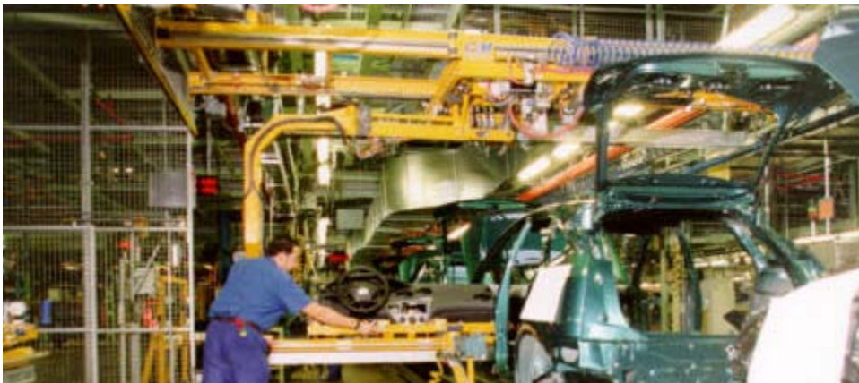
Fig. 2.6 Montaje del Panel de Instrumentos
