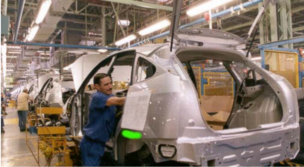
Fig. 2.3 Montaje de piezas a la carrocería en Trim en el actual FOCUS (Fuente: Documentación de Ford)
