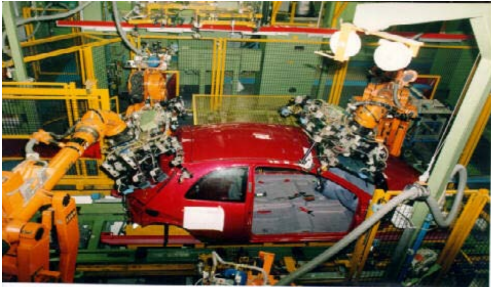
Fig. 2.7 Zona de montaje de los cristales del vehículo
