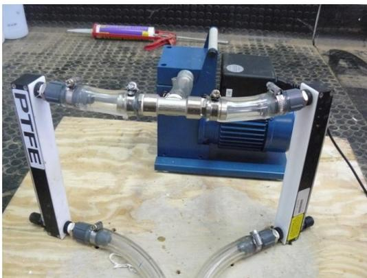
Figura 3.8.-Bomba y caudalímetros.
