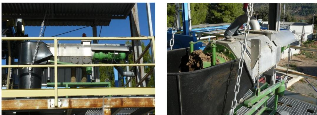
Figura 3.1. y 3.2 – Prensa de tornillo *mecánica segalés*® y detalle de la misma.
