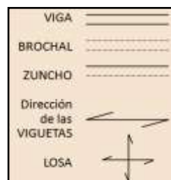
Figura 14: Leyenda gráfica de los elementos de un forjado unidireccional y losa. Fuente: elaboración propia
