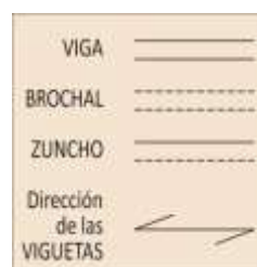
Figura 10: Leyenda gráfica de los elementos de un forjado unidireccional. Fuente: elaboración propia
