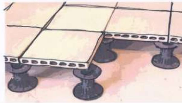
Imagen 2. Pavimento flotante. Fuente: elaboración propia
