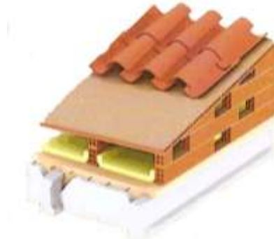
Imagen 5. Cubierta inclinada, ventilada o fría.
