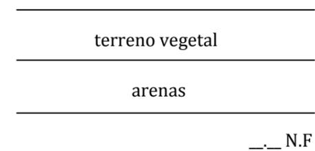
Con lo que optaremos por una Cimentación Directa de zapatas de hormigón.
