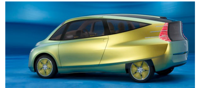
Fig 5.5. La marca Mercedes Benz sacó al mercado un diseño inspirado en el pez cofre para mejorar rendimiento aerodinámico, aumentar seguridad y comodidad. El diseño del automóvil se basa en la relación entre rigidez y peso que presenta el pez. Este es el claro ejemplo de que la biomímesis es aplicable a a todas las ciencias
