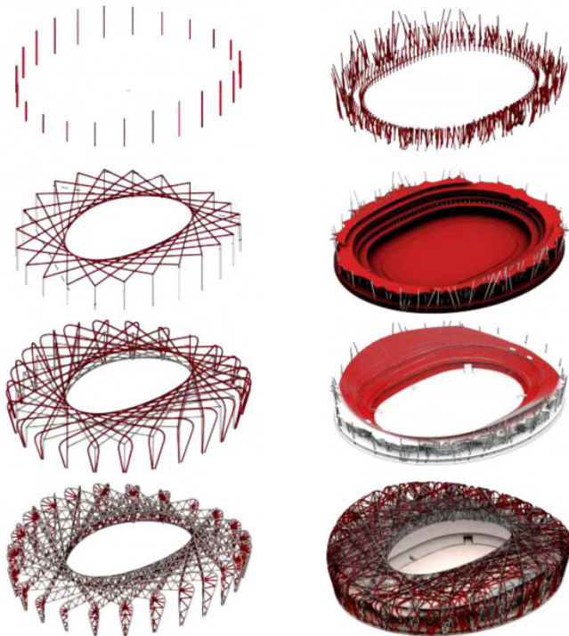
Fig 5.7. La estructura del estadio nacional es considerada una de las más grandes de acero del mundo. Parece caótica pero está detenidamente racionalizada. En primer lugar se colocan los 24 pilares que llevan la mayor parte de las cargas y definen la forma en planta y fachada
