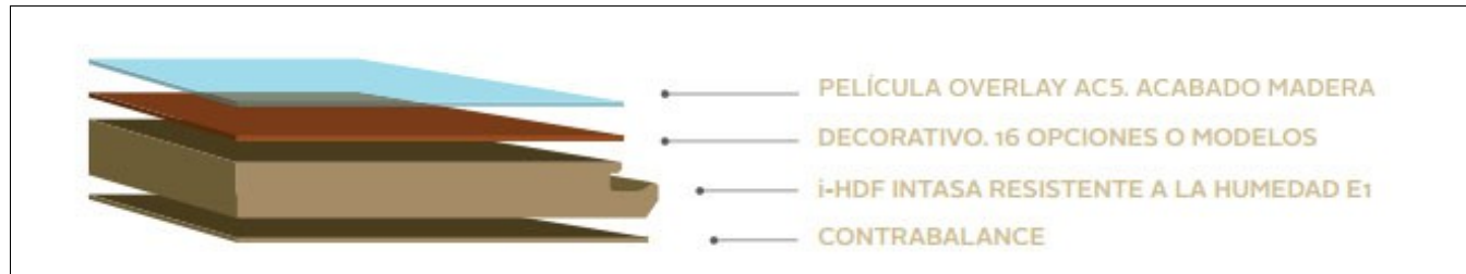
Sección del suelo laminado
