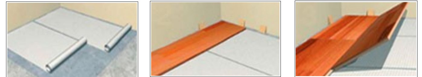
Colocación del suelo laminado
