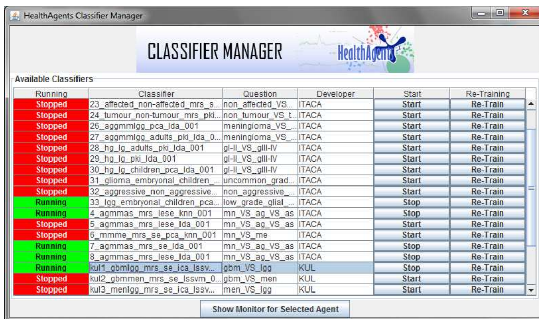
Figura 2.6: GUI del Classifier Manager. Desde esta herramienta los nodos de clasificación son capaces de gestionar los agentes Classifier Agent que están ejecutándose en el sistema para proceder a su mantenimiento o actualización.
