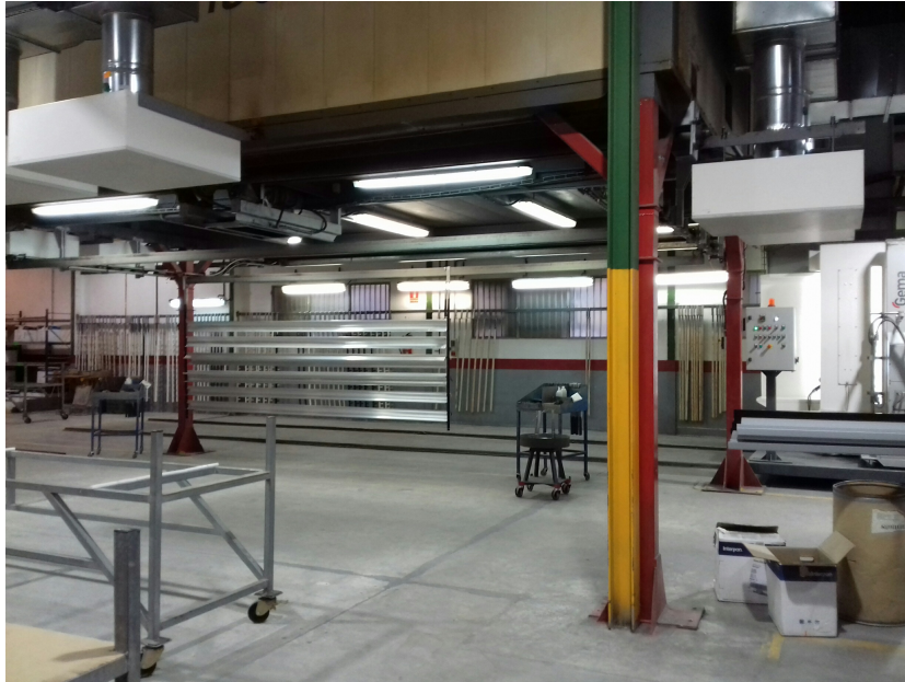
Figura 15: Cabina de lacado perfil dónde se observa que es la cabina la que se desplaza sobre los perfiles.
