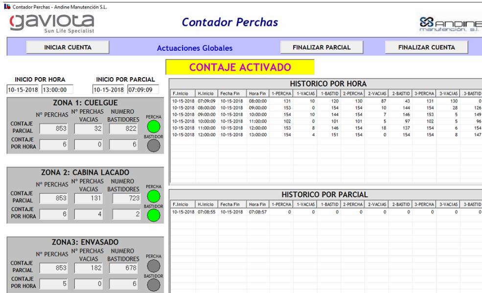
Figura 50: Programa asociado a la cadena del lacado para contar las perchas vacías respecto al total.
