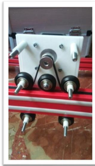
**ILUSTRACIÓN 37. Sistema de transmisión.**
