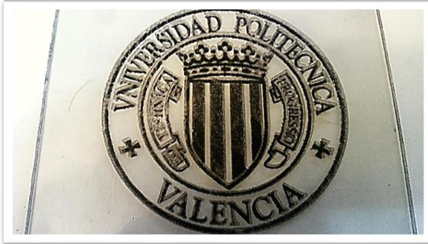
**ILUSTRACIÓN 67. Grabado láser en PMMA, muy baja reflectividad.**
