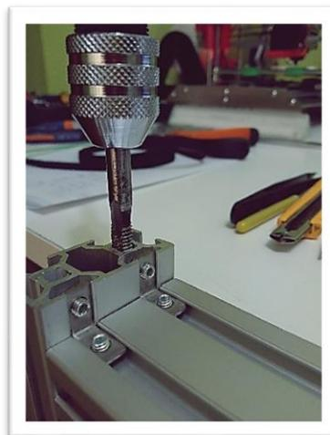
**ILUSTRACIÓN 41. Mecanizado para M6.**
