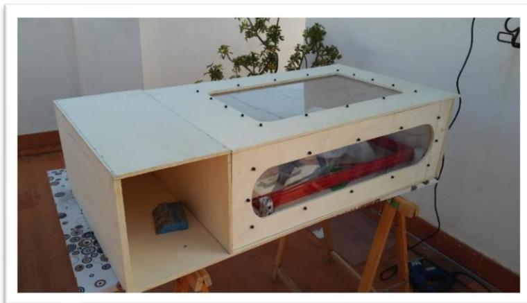
**ILUSTRACIÓN 51. Puerta de la cabina láser.**
