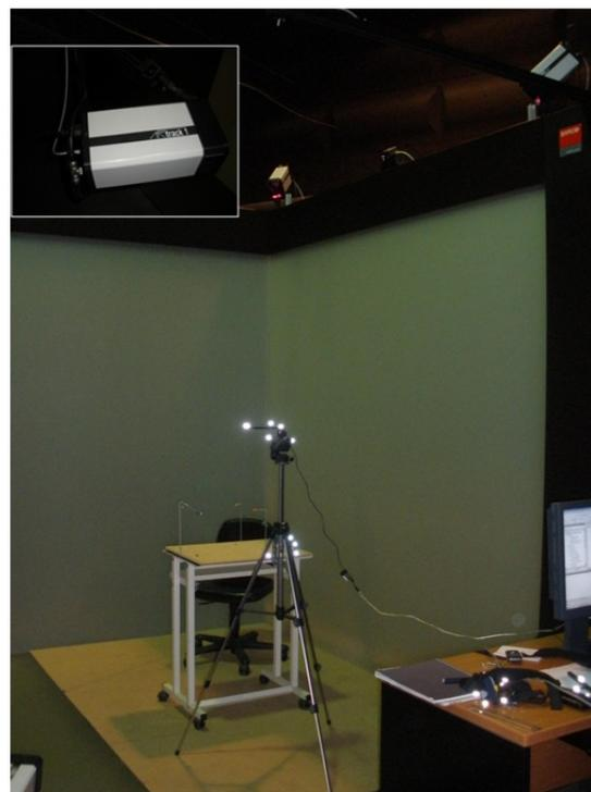
Figura 40. Esquema del sistema de captura ART con 6 cámaras infrarrojas.
