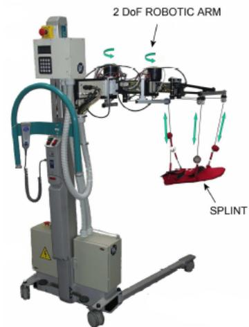
Figura 7. Robot de Rehabilitación MariBot de 5 GdL.
