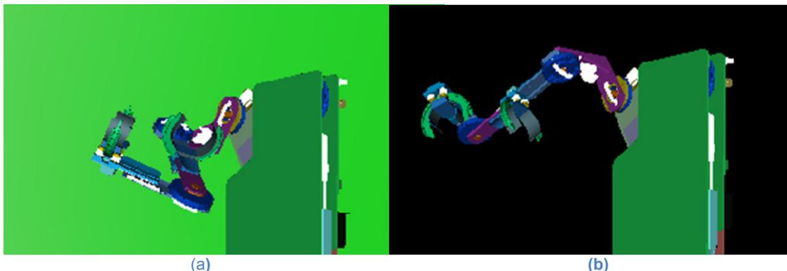
Figura 62. Configuraciones adoptadas por el Prototipo Virtual de IKO: (a) postura no ergonómica; (b) postura ergonómica.
