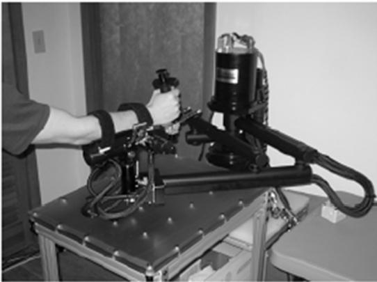
Figura 2. Robot planar de hombro y codo, con 5 GdL activos y 2 pasivos.
